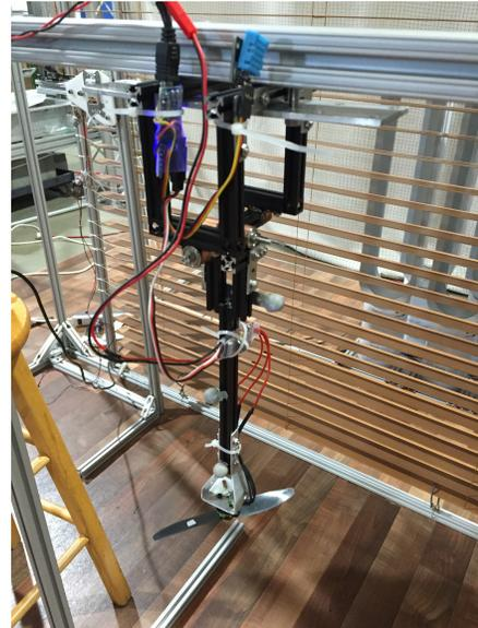
FIGURE 9: ROTOR-PENDULUM STAND
